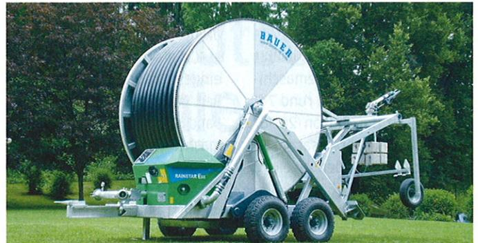
*Mit dem 4-Gang-Schaltgetriebe kann die Einzugschwindigkeit des Regners zwischen 0 und 140 m/h variiert werden.*
