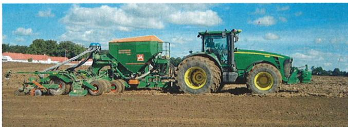
*Der 3000 l große Sätank (3000 l mit Tankaufsatz) ist weit vorne angeordnet, so dass ein großer Teil des Gewichts auf der Hinterachse des Schleppers liegt.*
