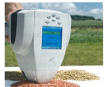
*Das tragbare Spektrometer wiegt nur 1,8 kg und wird über den integrierten Li-Ionen-Akku mit Strom versorgt.*
